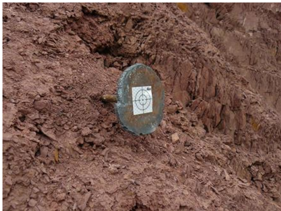
5 Сурет – Борттың еңісіне салынған бақылау репері
