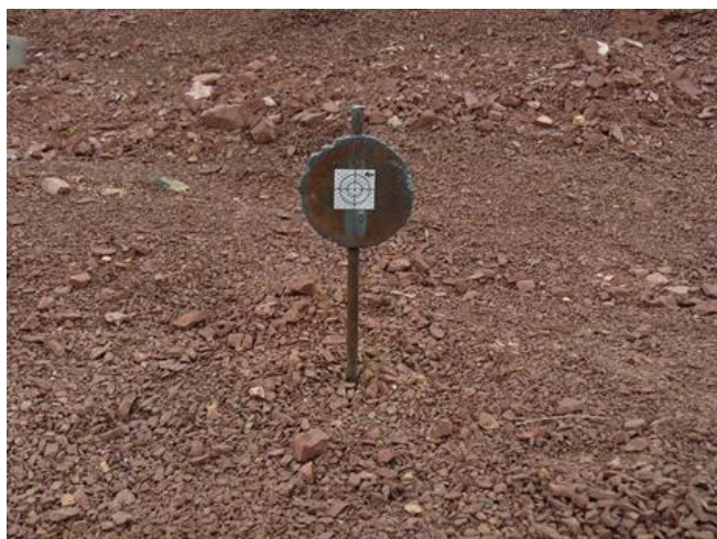
6 Сурет – Кертпешке салынған негізгі бақылау репері
