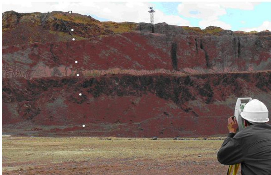
4 Сурет – Карьердің өндірісте 1-N профильді сызықтармен бақылауы
